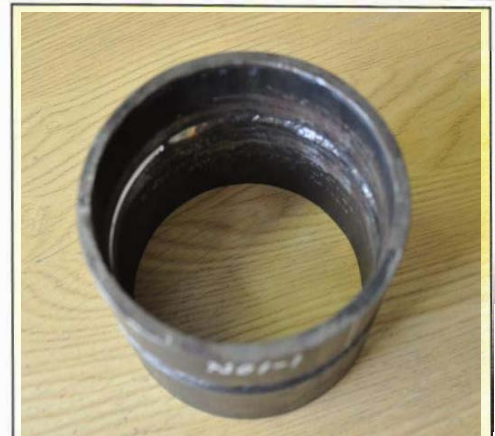
萬能 309 能滲入管道內，並有效地防止背面焊縫氧化。
