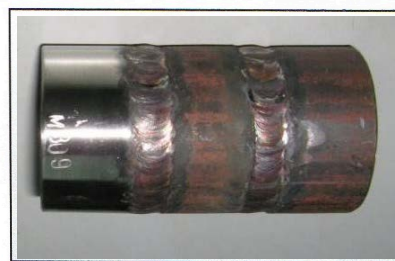
萬能 309 ® 焊接樣品 – 不銹鋼管與碳鋼管與碳鋼
